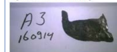
A3 Anker op inonel gelast wel achter tegel Tegel was niet meer aanwezig
