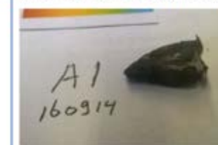
A1 Anker op inonel gelast niet achter tegel
