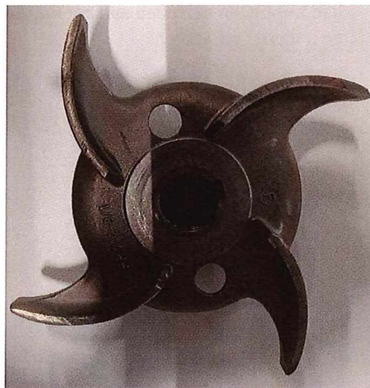
Casus 2: de waaier van de centrifugaalpomp. Van elke vleugel in totaal 1cm afhalen (in fases van 0,5cm)
