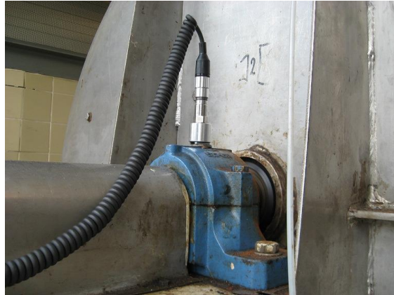
Figuur 19.4 Opnemer verticaal op lager.
