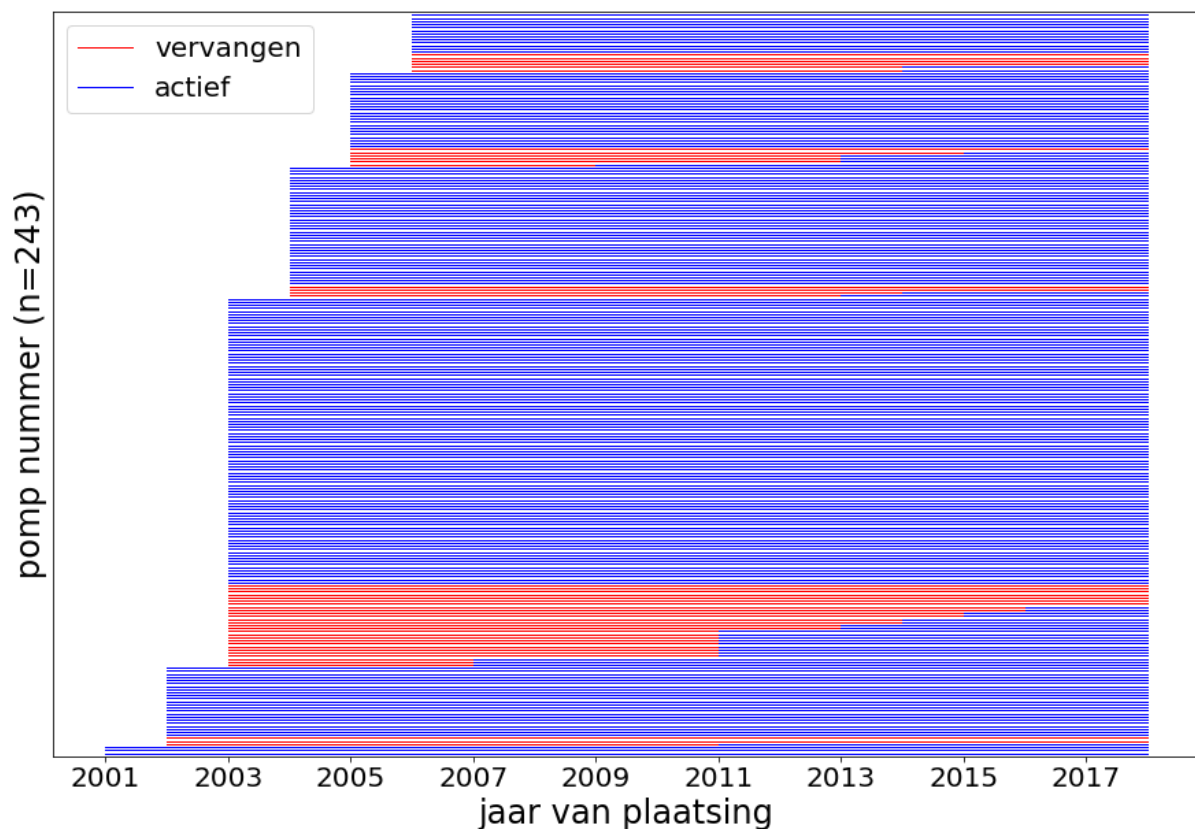
Figuur 1. Plaatsing en vervanging van 243 warmtepompen in de wijk Ouverture.
