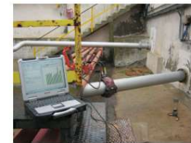
Figuur 2/3: Wavemaker in het veld met een opblaasbare en een vaste meetring
